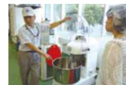
生産効率を上げるため製造過程の一部機械化目指し、生地を混ぜる「ニーダー」という大型ミキサーのような機械を導入しました。ところが普段使っている材料を同じ比率で混ぜても、手作り時と同じような生地ができません。プラント
